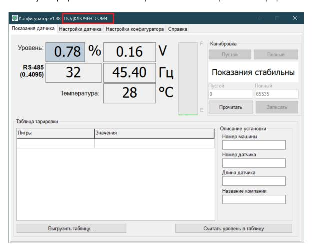
Если данные из датчика не будут прочитаны, необходимо проверить на вкладке «Настройки конфигуратора» наличие и правильность установленного СОМ порта (статус подключения указан в заголовке программы, выделено красной рамкой).
