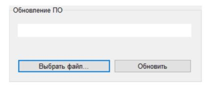
**Важно:** Если во время обновления ПО произошла ошибка или файл установился не до конца, нужно переподключить ДУТ к УНД (преобразователь интерфейса USB <-> RS-485) и в первые 2-3 секунды нажать кнопку «Обновить».
